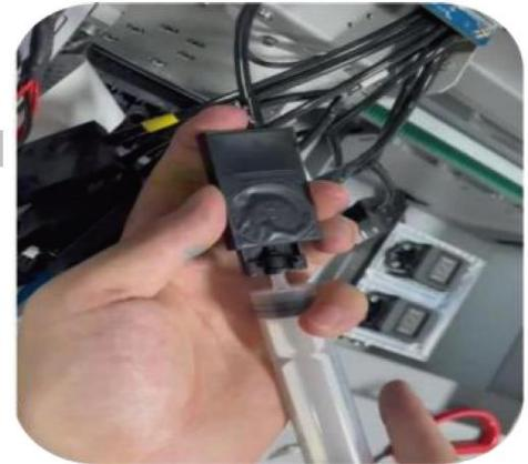
2. インクチューブのチャンネル配置のジョグルに従って、インクサックをノズルに垂直に挿入します
