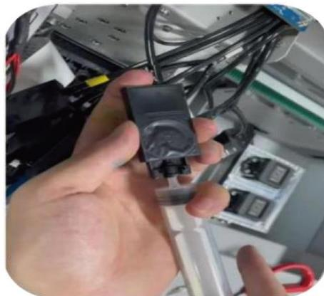
2. インクチューブのチャンネル配置のジョグルに従って、インクサックをノズルに垂直に挿入します
