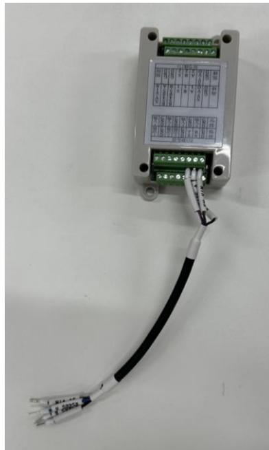
1. パトライトコントロールボックスとコントローラーを接続します。赤枠の配線をコントローラーへ接続します。コントローラーは制御部にある黒色のボックス状のものになります。
